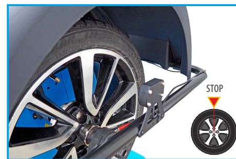
AUTOMATYCZNE POZYCJONOWANIE KOŁA W MIEJSCU NIETYWAŻENIA
