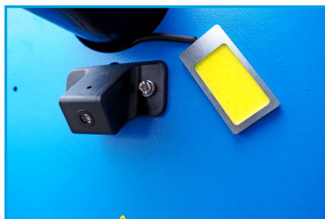
WSKAŹNIK LASEROWY ORAZ OŚWIETLENIE WNĘTRZA KOŁA
