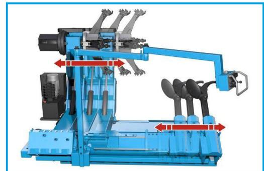
**SLIDING GRIPPER WITH HEAD**
