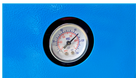
MANOMETR CIŚNIENIE POWIETRZA
